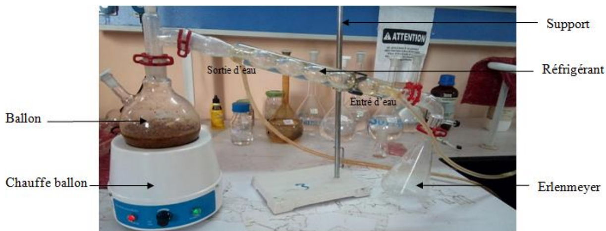
Figure III.3: Montage de la méthode d'hydrodistillation.
