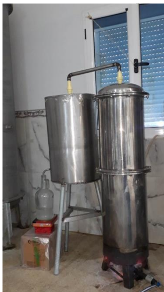
Figure 15: L'appareil d'extraction (Alambic inox alimentaire 304) ( Prise personnelle )
