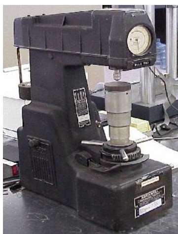
Figure IV.2: Essais mécaniques: Duromètre Rockwell.
