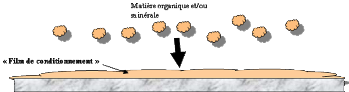
Figure III. 5. : Formation du film de conditionnement sur la surface.
