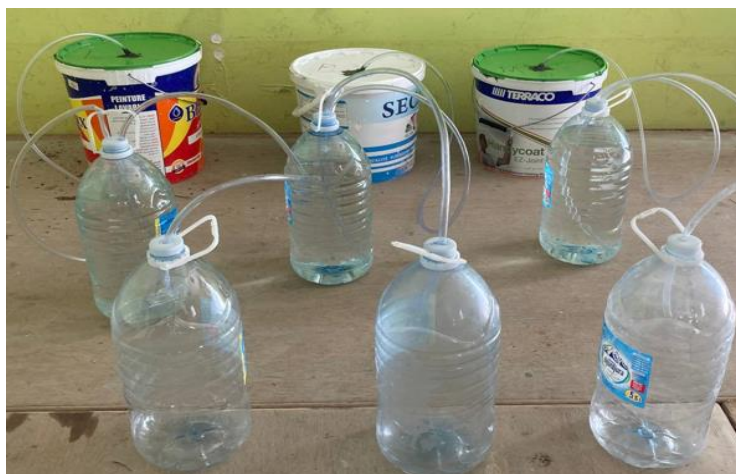
Figure 09. Le digesteur utilisé.
