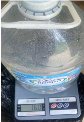
Figure14. Déterminer le volume de biogaz avec une balance.
