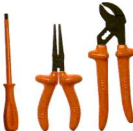
Figure III.10 : Outils à main isolés
