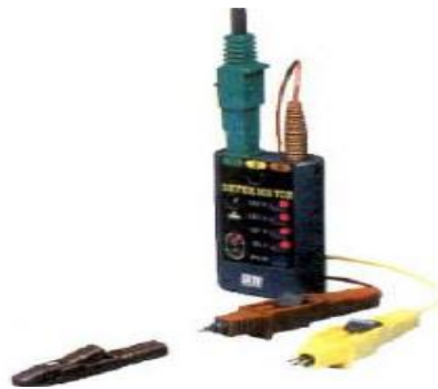
Figure III.18 : Vérificateur d'absence de tension en BT
