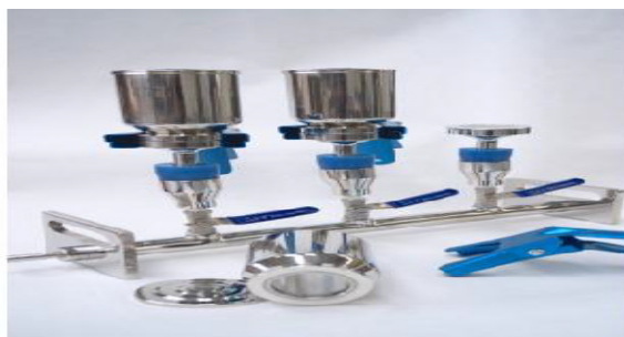
Figure 25 : Rampe à filtration sous vide.
