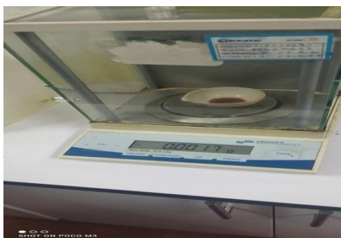
Figure IV.8 : l'aspect de l'échantillon après avoir été exposé à une température de 525°C.
