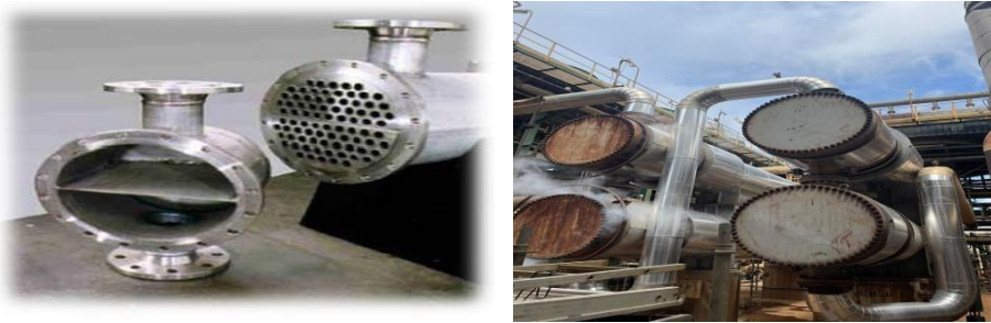
Figure II.21 : Chambre de distribution de type A
