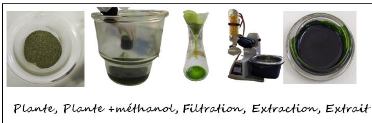
Figure 7. Les étapes de l'extraction méthanolique de Clematis cirrhosa .
