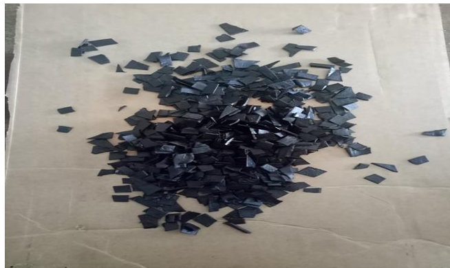
Figure V.3 : Photo représentatif du mélange TPNR-NC découpé en petits morceaux [68].
