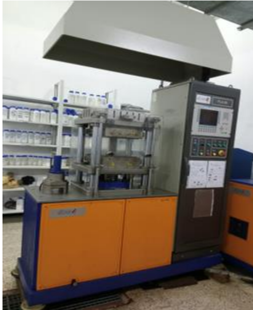
Figure V.4 : Photo représentatif d'une presse hydraulique automatique.
