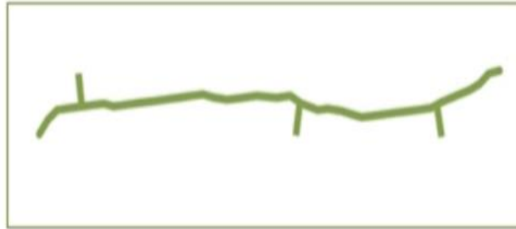
Figure II.1 : Structure d'une chaîne de polyéthylène haute densité PEHD [29].
