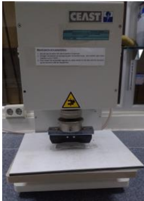
Figure V.5 : Appareillage d'une poinçonneuse « Presse pneumatique à découper ».
