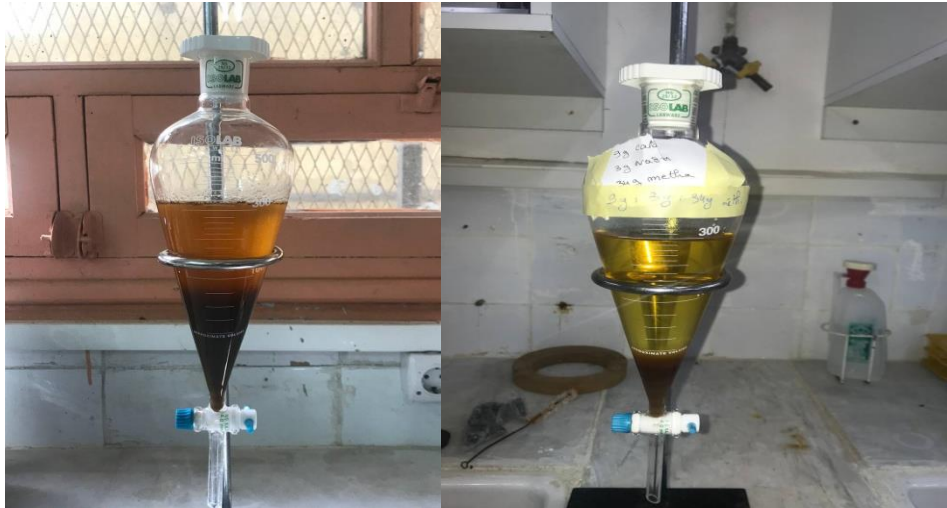
Figure III.6. Avant et après la décantation (séparation) de mélange réactionnel
