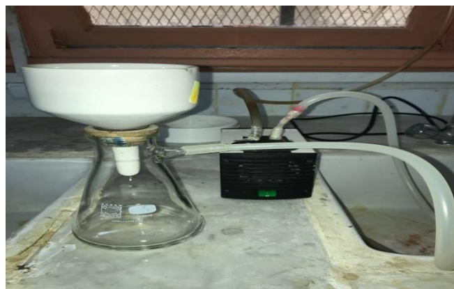
Figure III.5. Appareillage de filtration sous vide
