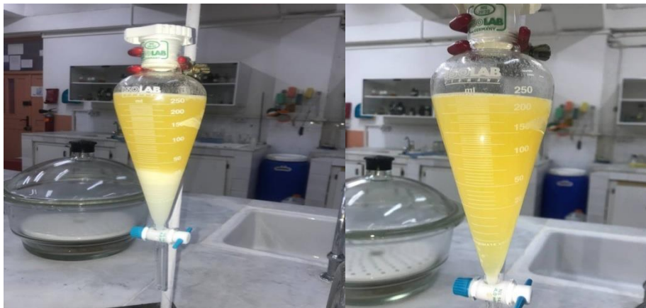
Figure III.7. Avant et après lavage du biodiesel
