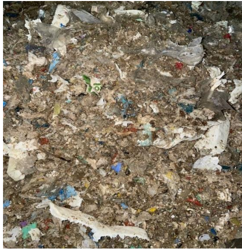
Figure IV.6: Aspect des déchets DASRI après broyage et stérilisation par le banaliseuseur (Photo originale 2026).
