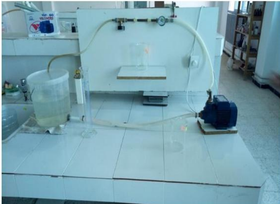
Figure IV.9. Montage de la microfiltration
