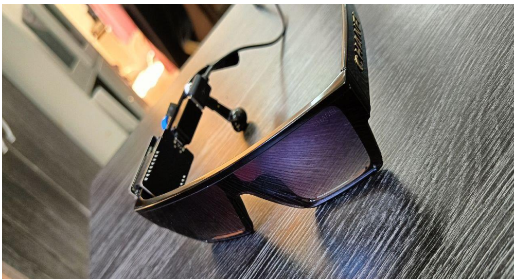
Figure 58: Représente la face interne de premier prototype des lunettes intelligentes « Smart Eyes »
