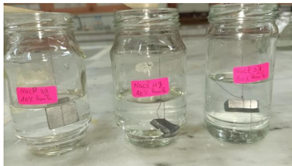
Figure III.15. Immersion des échantillons avec mélange (verniss+ huile traitée) dans la solution de NaCl.
