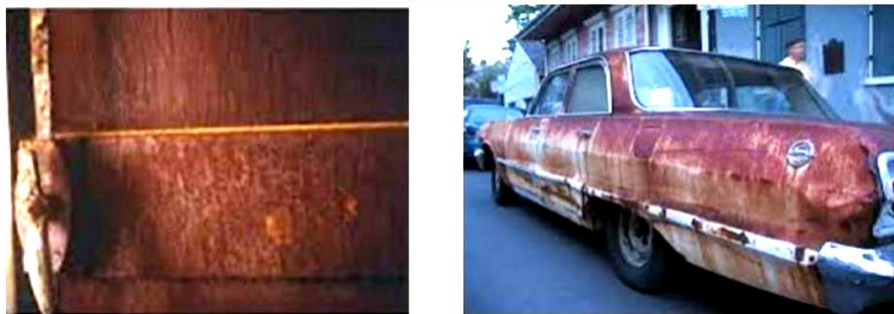
Figure I.1. Corrosion généralisée : exemple d'une porte et véhicule corrodés. [6]
