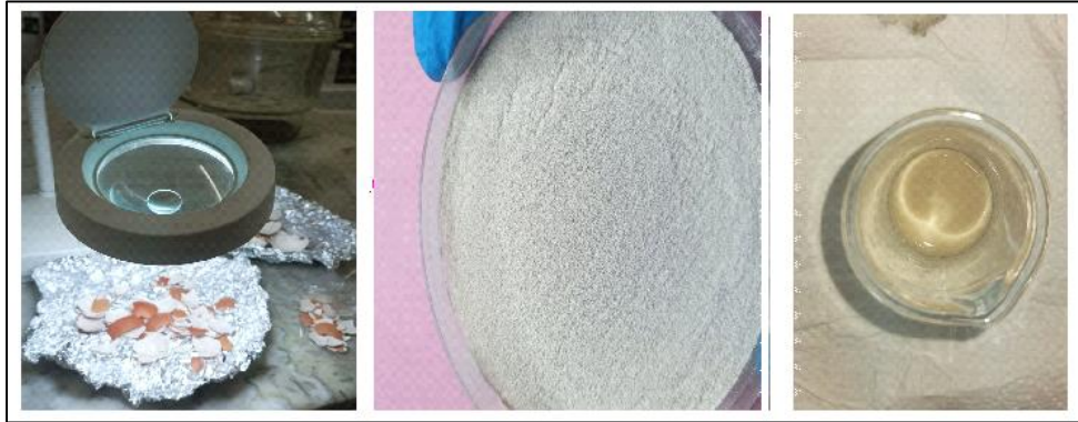
Figure III.8. Préparation de la poudre de coquille d'œuf et son incorporation dans le mélange.
