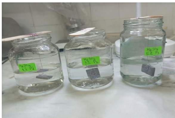
Figure III.16. Immersion des échantillons avec mélange (verniss + huile traitée + nanoparticules de coquille d'œuf) dans la solution de H_2SO_4 .
