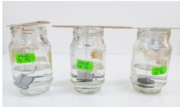
Figure III.17. Immersion des échantillons avec mélange (verniss+ huile traitée+ poudre de coquille d'œuf) dans la solution de NaCl.
