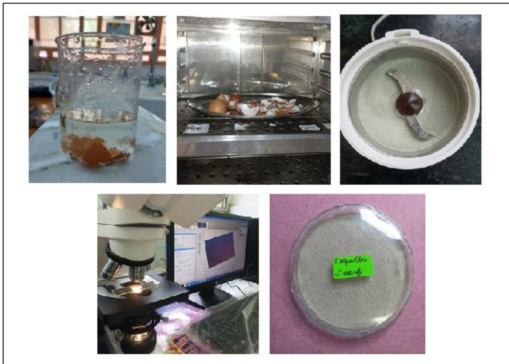
Figure III.5. Préparation de la poudre de coquille d'œuf.
