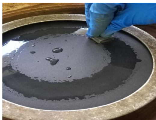
Figure III.6. Opération de Polissage de l'échantillon sur polisseuse mécanique.
