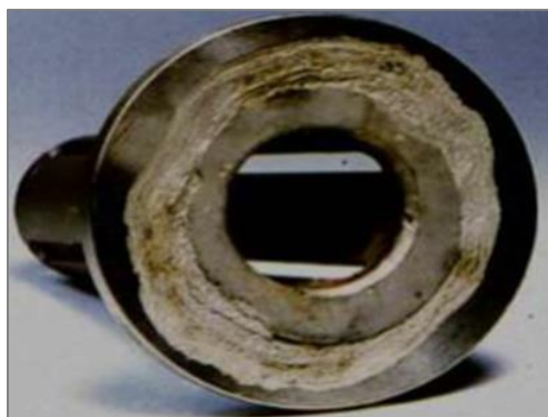
Figure I.5. Corrosion par crevasse sous un joint. [7]
