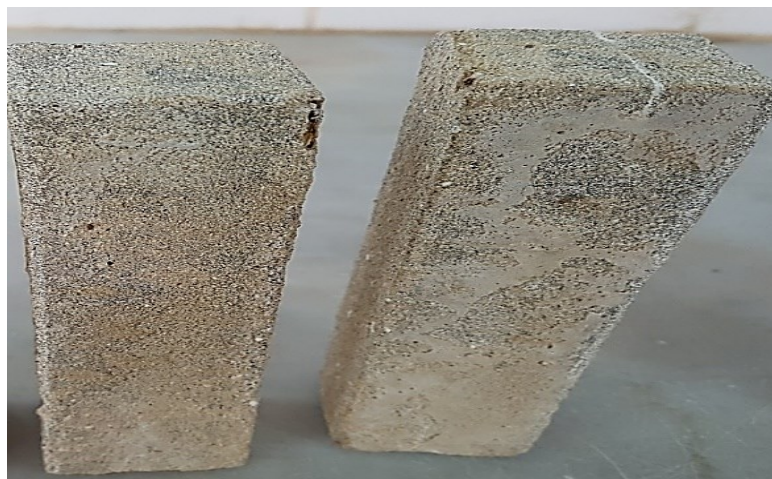
Figure V-8 : Epreuves traitées par l'acide HCL
