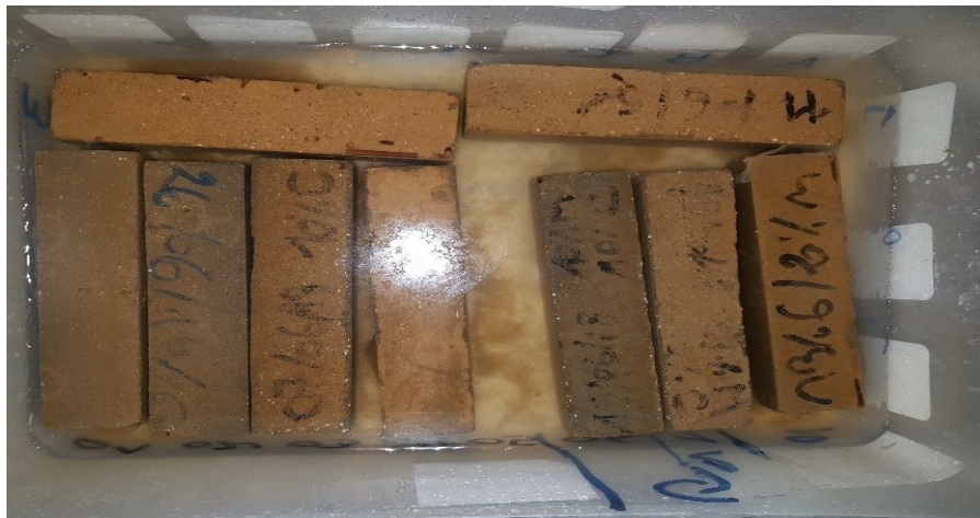
Figure III-17: Conservation des éprouvettes dans une solution de 3% CH 3 COOH
