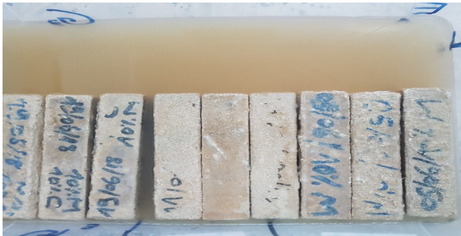
Figure III-15: Conservation des éprouvettes dans une solution de 3% H_2SO_4
