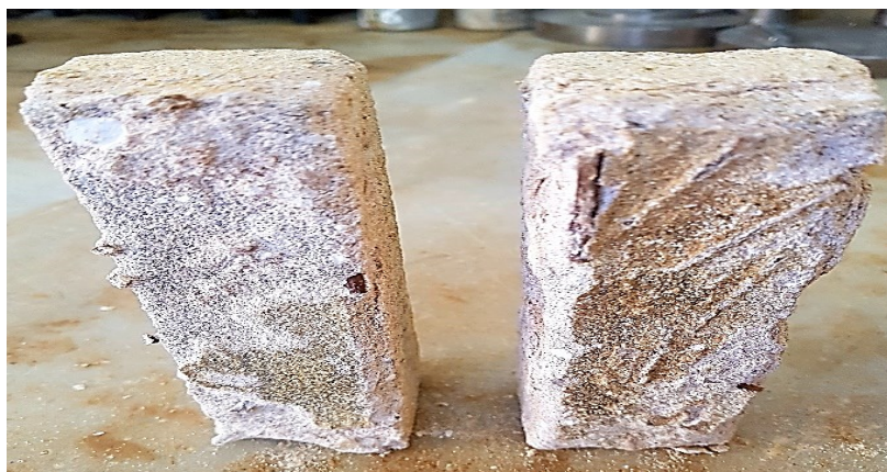
Figure V-4: Eprouvettes traitées par l'acide H_2SO_4
