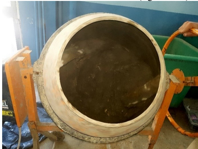
Figure III-1: Malaxeur de béton
