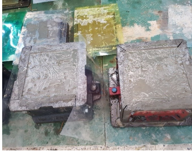
Figure III-2: Remplissage des moules
