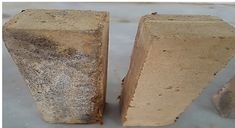
Figure V-12 : Eprouvettes traitées par l'acide \text{CH}_3\text{COOH}
