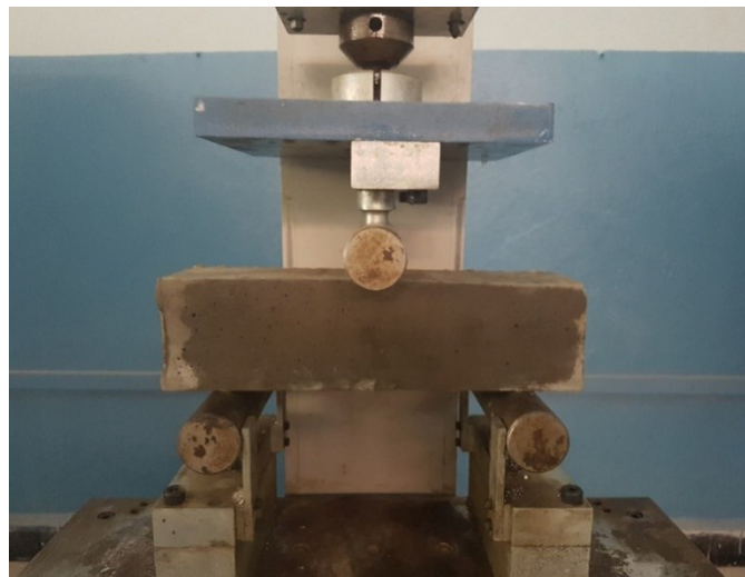
Figure III-8: Essai de traction par flexion
