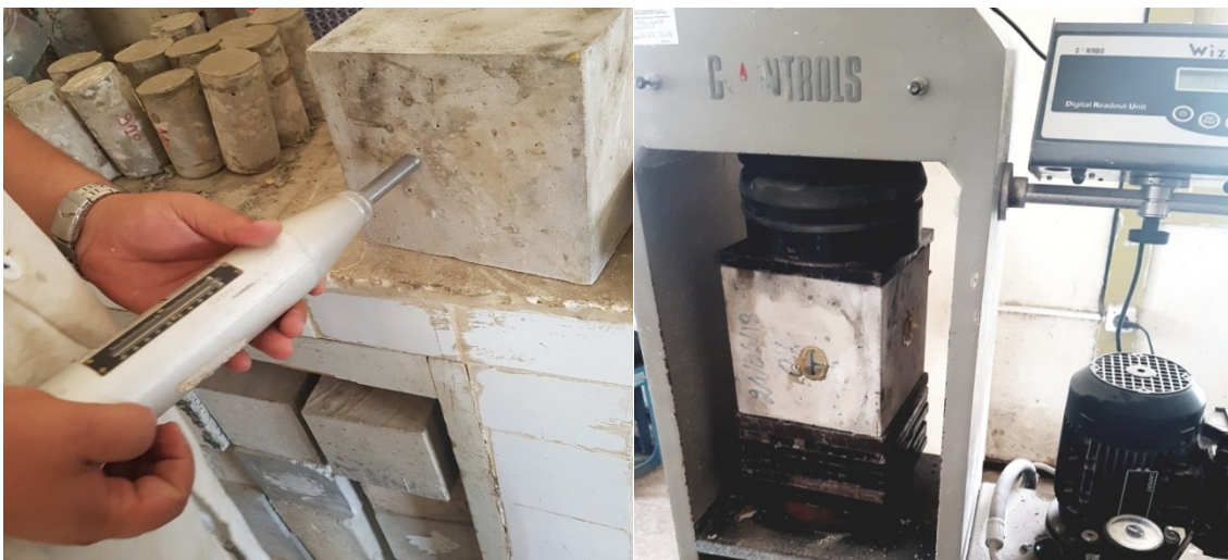
Figure III-10: Essai au scléromètre
