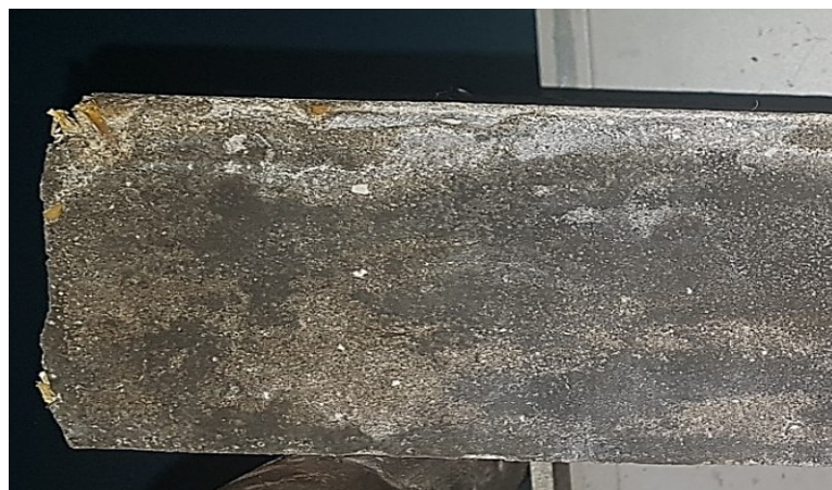
Figure V-16 : Eprouvette traitée par l'acide NaCl
