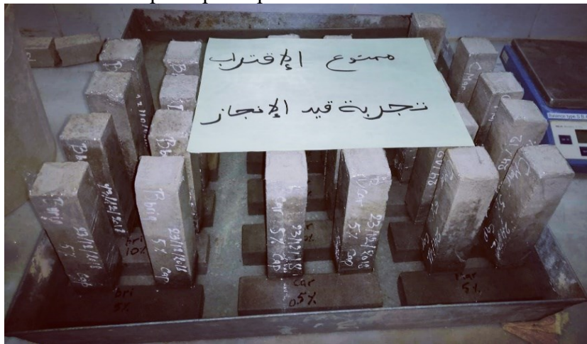
Figure III-13: Essai d'absorption par capillarité.
