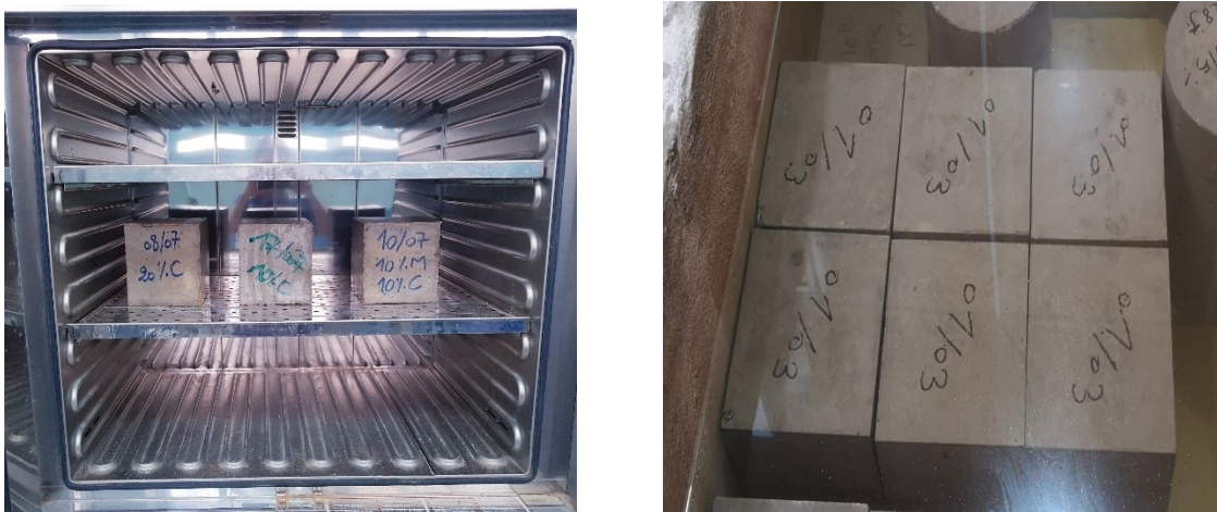
Figure III-12: Essai d'absorption par immersion.
