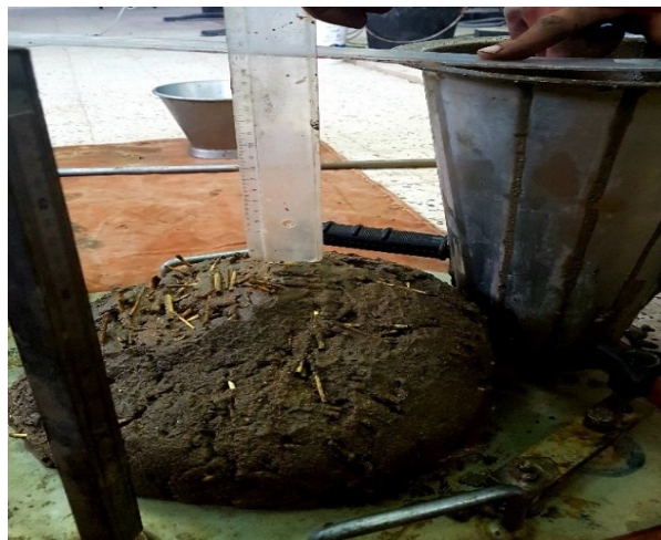
Figure III-4: Affaissement au cône d'Abrams
