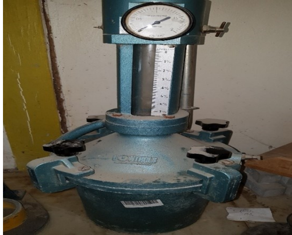
Figure III-5: Aéromètre à béton
