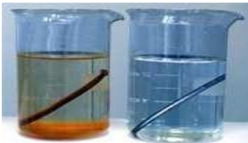
(a) sans inhibiteur de corrosion (b) avec inhibiteur de corrosion
