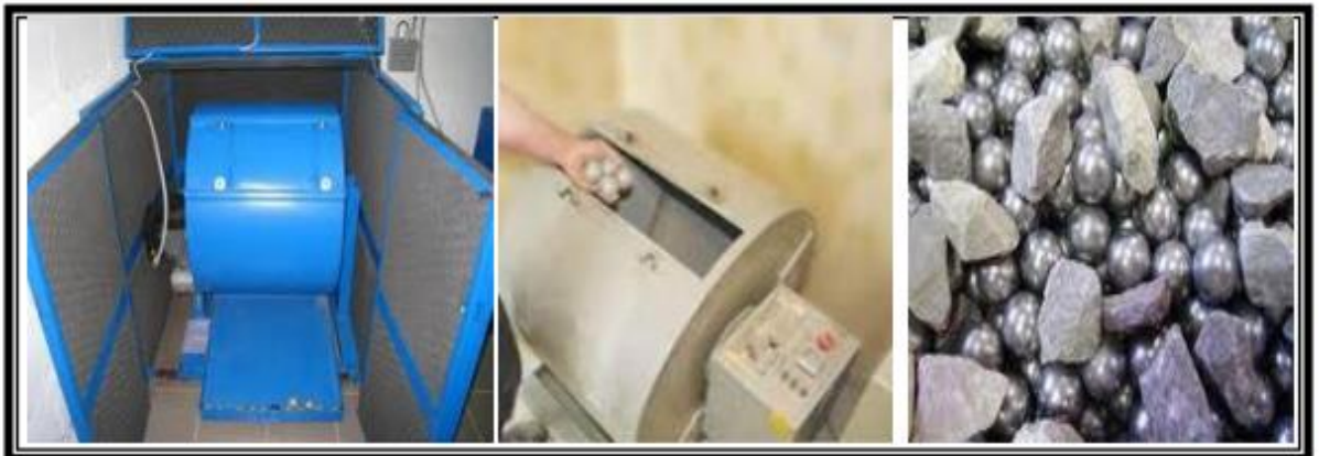
Fig.IV.8. Essai los Angeles.
