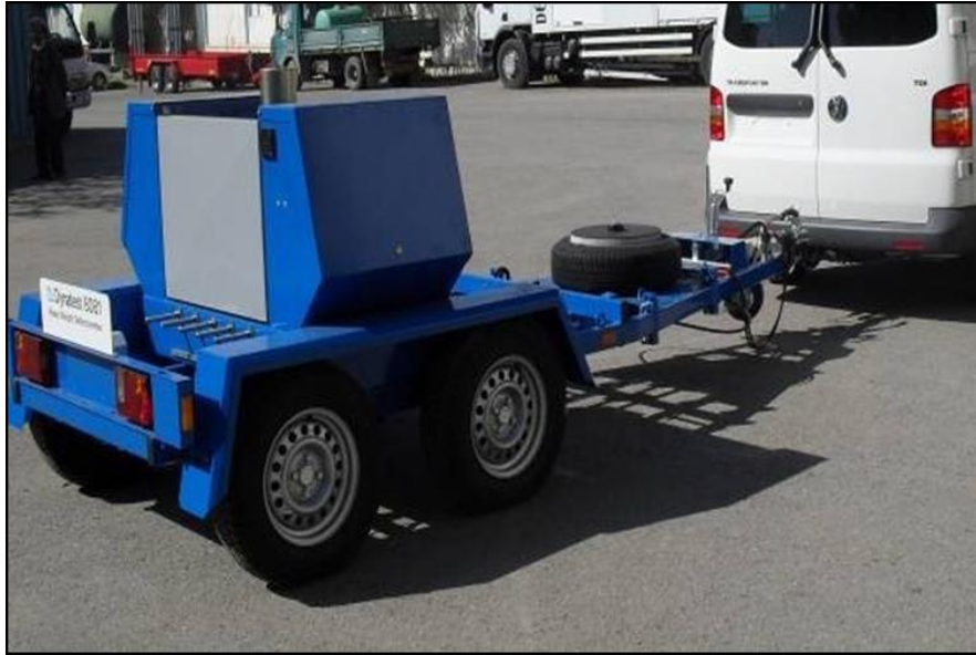
Fig II. 9: L'appareil d'acquisition HWD du CTPP
