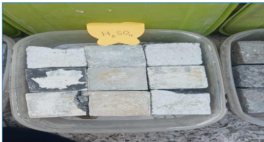
Figure III.20: Echantillons immergés dans une solution de 4% de H 2 SO 4
