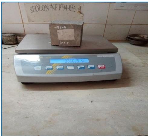
Figure III. 16: Essai d'absorption par immersion
