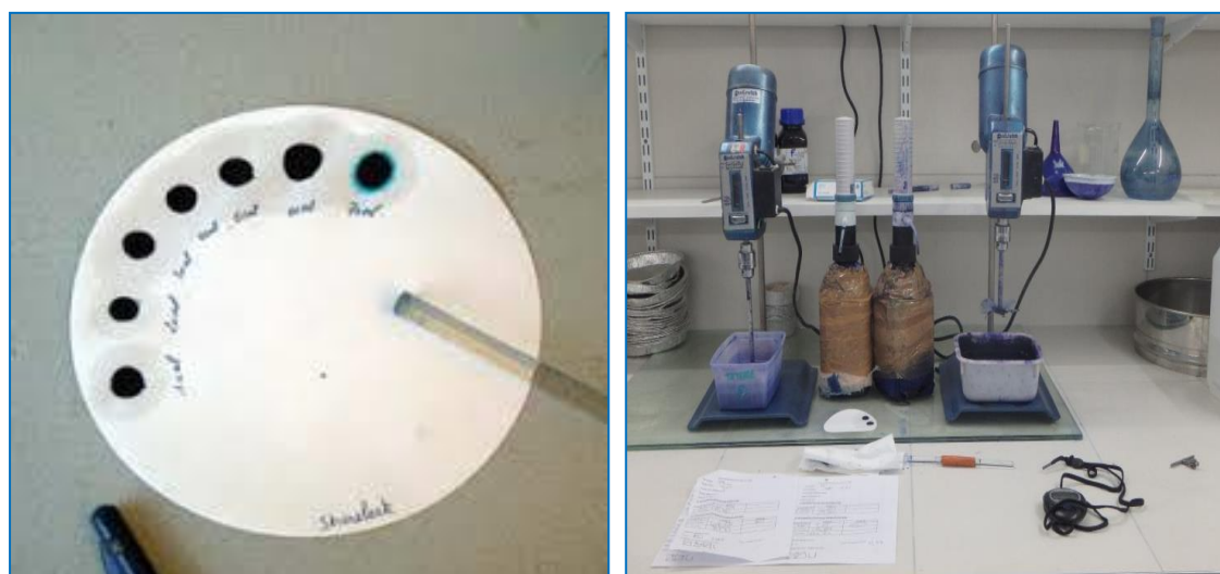
Figure II.5 : Essai au Bleu de Méthylène
