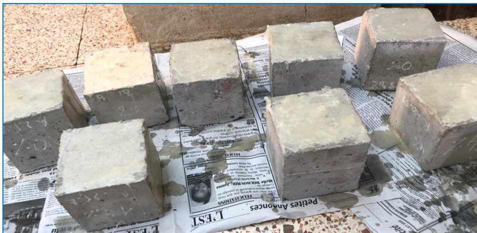
Figure III.18: Essai pénétration des chlorures
