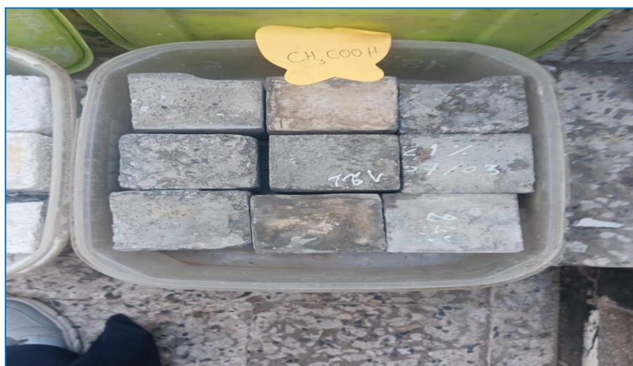
Figure III.21: Echantillons immergés dans une solution de 4 % d' CH 3 COOH
