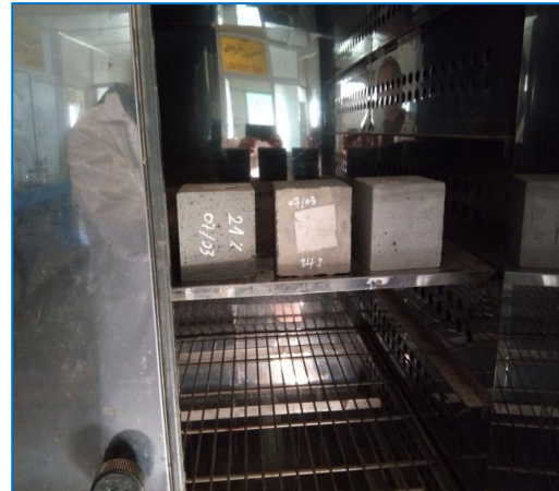
Figure III. 16: Essai d'absorption par immersion
