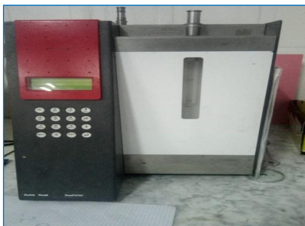
Figure II.8: Mesure de la SSb
