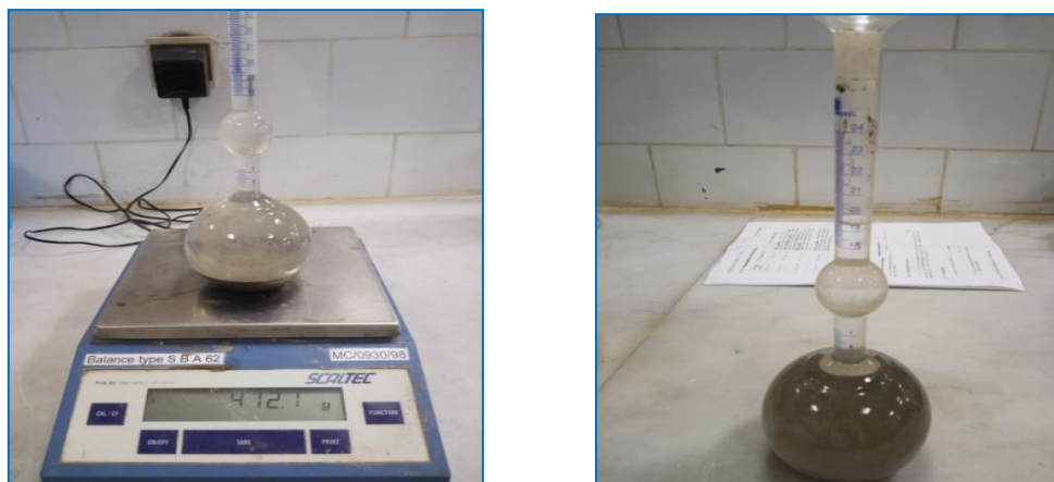
Figure II.7: Mesure de la densité
