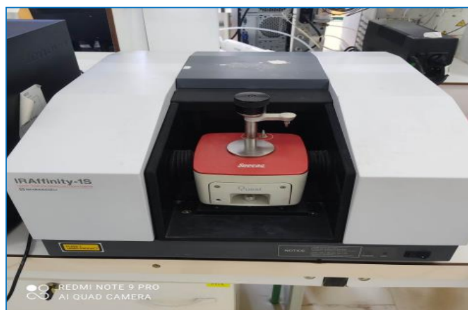
Figure III.24: Spectrophotomètre infrarouge à transformée de Fourier
