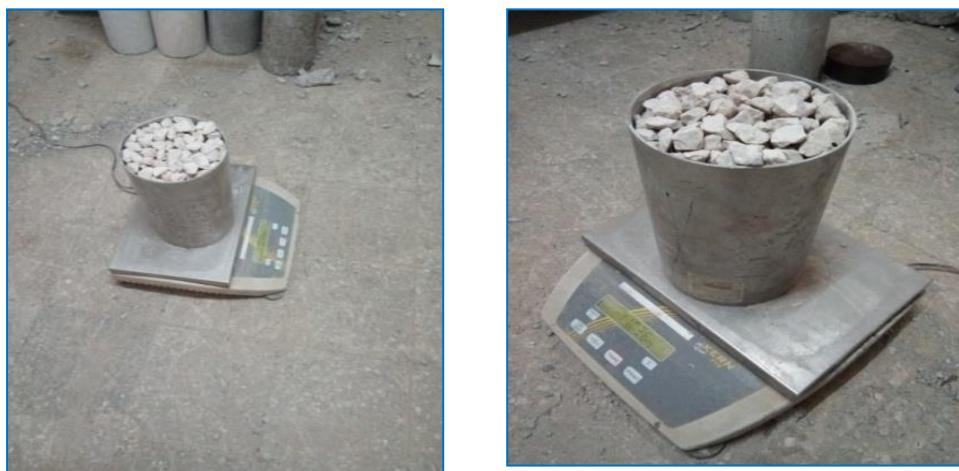
Figure II.3: Mesure de la masse volumique apparente
