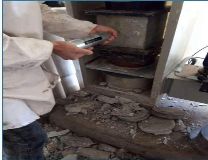
Figure III.14: Essai au scléromètre
