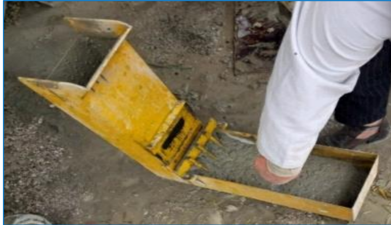
Figure III.9: Essai de la boîte en L
