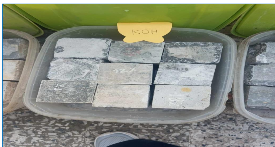
Figure III.22: Echantillons immergés dans une solution de 4% de KOH
