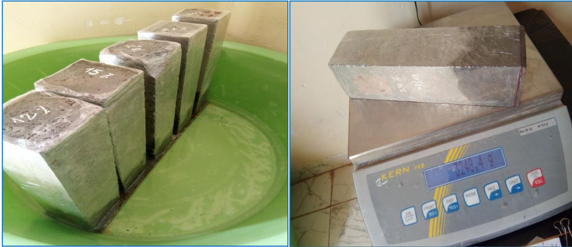
Figure III. 17: Essai d'absorption capillaire
