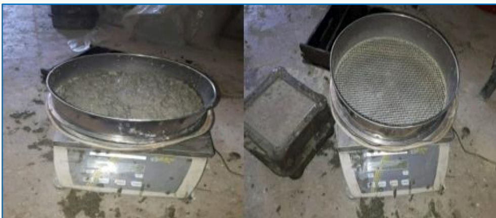
Figure III.10: Essai de stabilité au tamis
