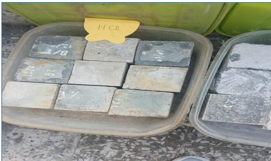
Figure III.19: Eprouvettes immergées dans une solution de 4% d'HCL
