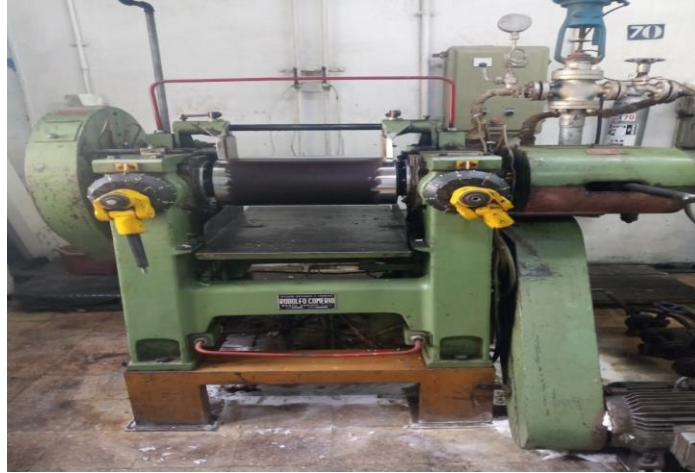
Figure. 3 : La calandre utilisée dans la préparation des composites.
