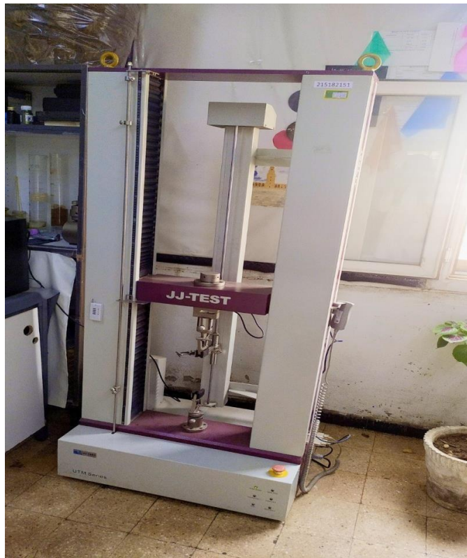
Figure. 6 : La machine d'essai de traction utilisée.
