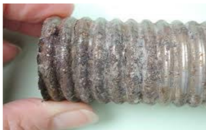
Figure .I.12 : Corrosion sous contrainte.
