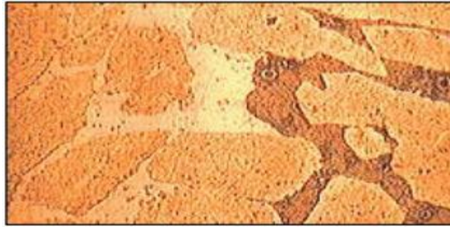
Figure I.7 : Coupe métallographique montrant une corrosion sélective d'un laiton
