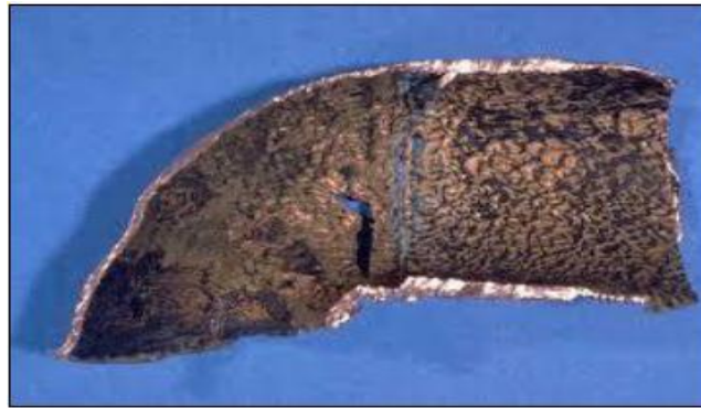
Figure. I.6 : Corrosion avec érosion. [12]
