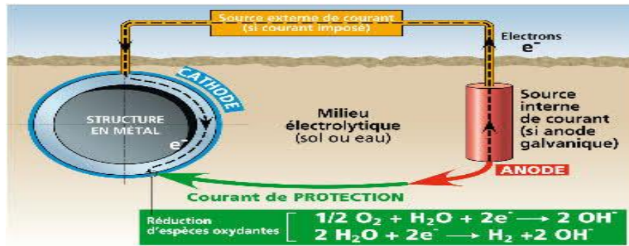
Figure I.14 : Principe de la protection cathodique par courant imposé. [18]
