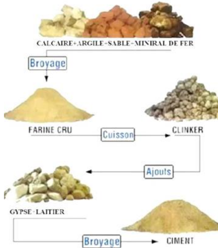
Fig. I.2 :les étapes de la fabrication du ciment [4].
