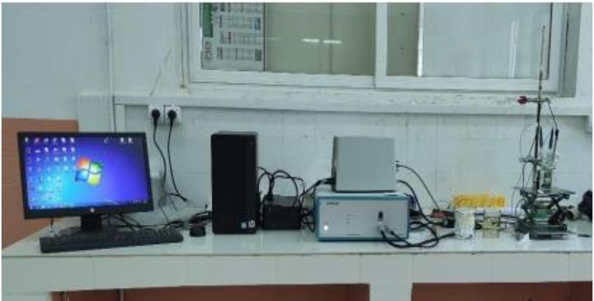
Figure 38 : Schéma et Dispositif de mesure d'une courbe de polarisation potentiostatique.
