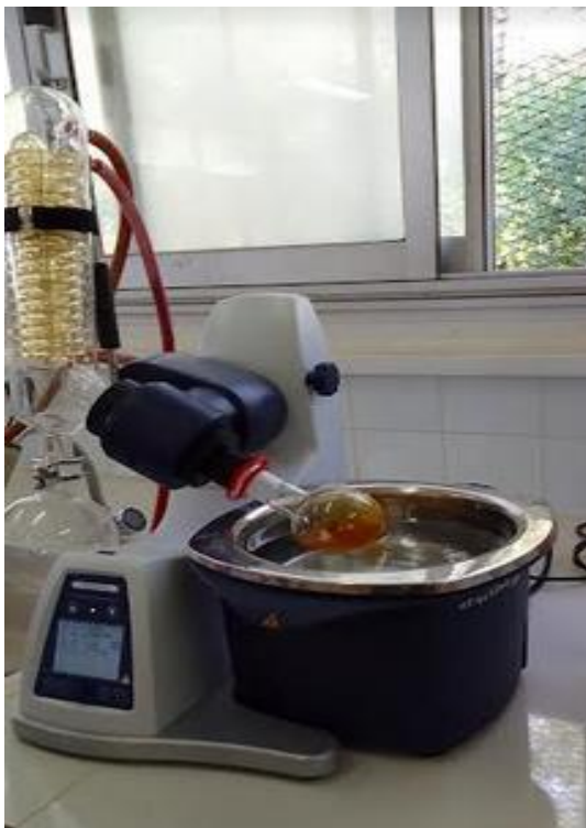
Figure 34 : Représentation d'extrait brut concentré sous pression réduite au rota-vapeur.
