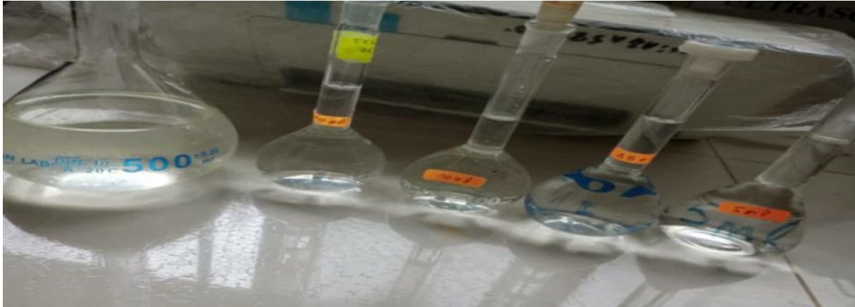
Figure 27 : Représentation des échantillons après dilution en fonction de la concentration.
