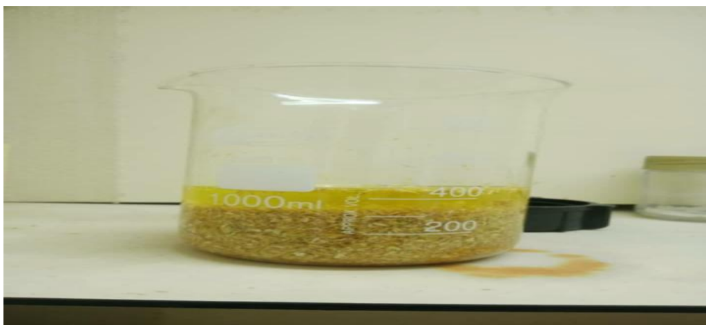
Figure 29 : Mélange préparé à partir de 300ml méthanol et la camomille.
