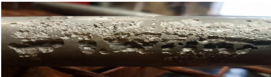
Figure4: Le principe de la corrosion caverneuse
