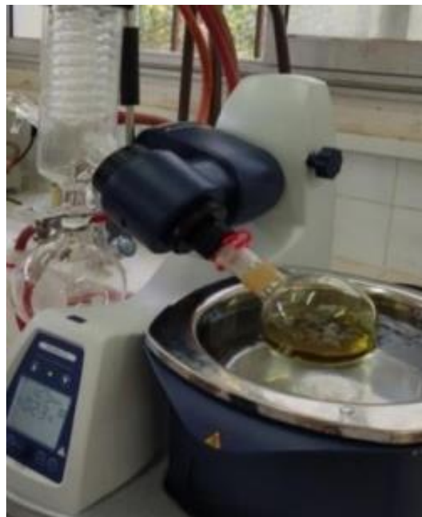
Figure 34 : Représentation d'extrait brut concentré sous pression réduite au rota-vapeur.
