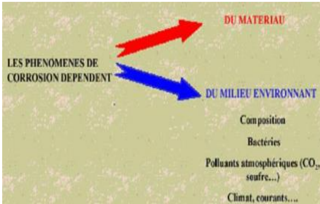
Figure 1: La nature des paramètres dues la corrosion [4].
