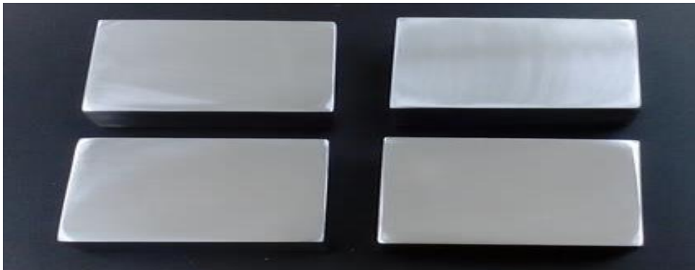
Figure 25 : L'état de la surface d'acier X60 après le polissage destiné à l'observation optique.
