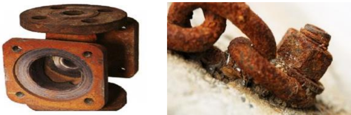
Figure 2 : Corrosion générale (rouille) d'une pièce en acier
