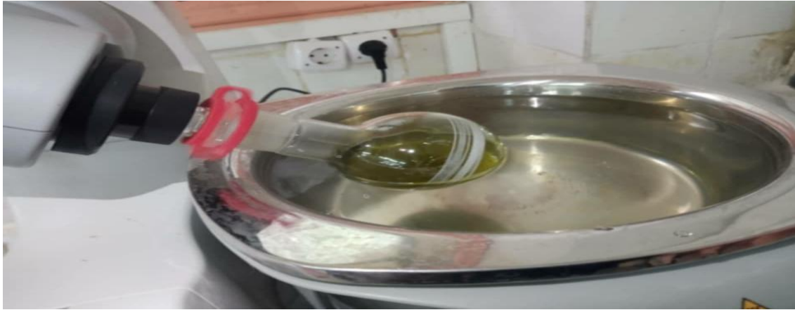
Figure 33 : Le processus de séparation des échantillons par le rota-vapeur.
