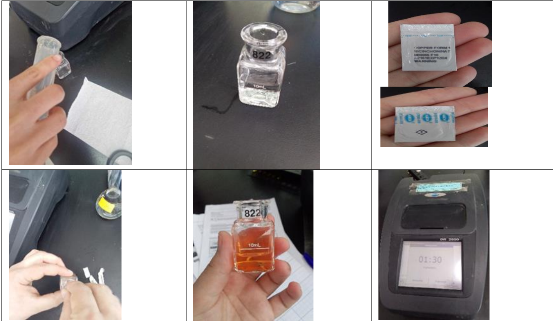
Image 22 :Étapes pour détecter les métaux, et la couleur montrée sur l'image appartient à Fe, à chaque métal et à son détecteur.
