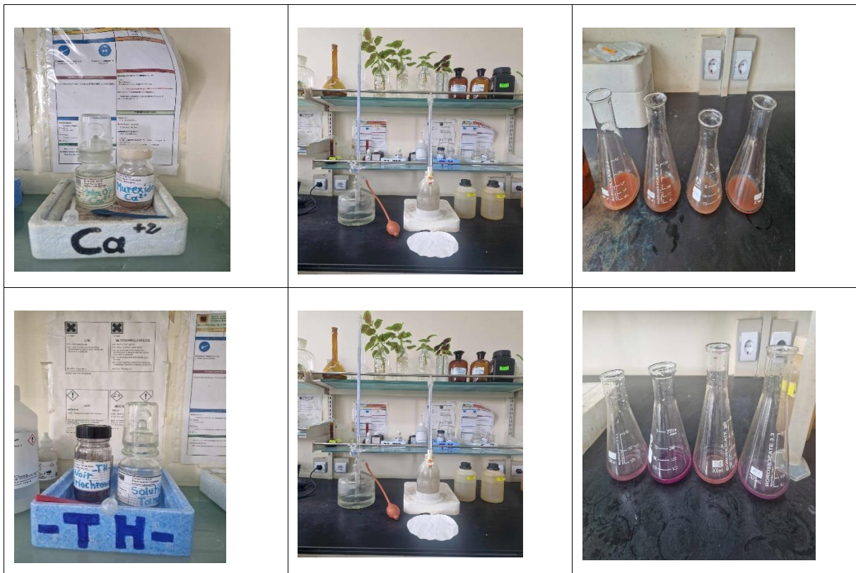
Image 15 : Étapes de détection Détermination de la dureté totale ( TH ) et Détermination de Calcium( \text{ca}^{++} ) et magnésium ( \text{mg}^+ ) .
