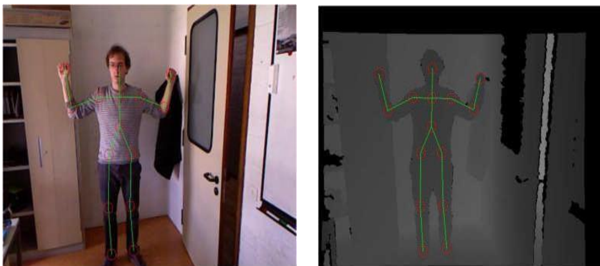
Figure III.8 : Articulations détectées par NITE. Affichées sur la carte de profondeur et sur couleurs.
