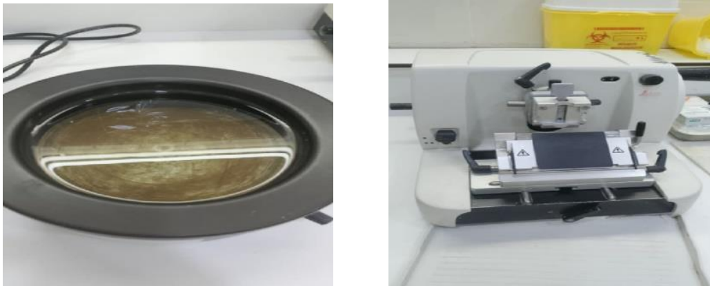
Figure 20: Etapes de la microtomie, Flottaison du ruban sur le liquide d'étalement ( Photo originale, 2025 ).
