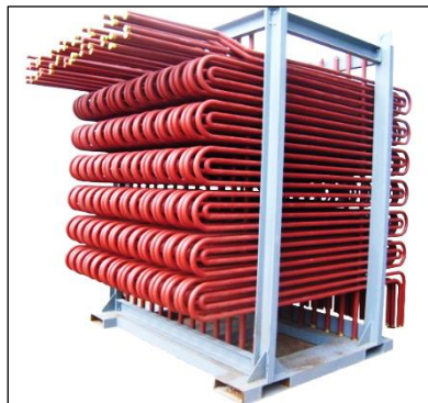
Fig. I.7 : Surchauffeur d'une chaudière.[7]
