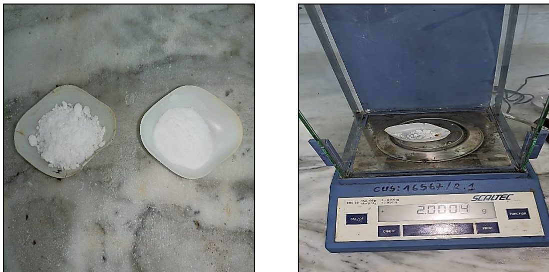
Figure III.13 : pesage 2 g de \text{CaCl}_2 \cdot 2\text{H}_2\text{O} et 2 g de \text{NaHCO}_3 .
