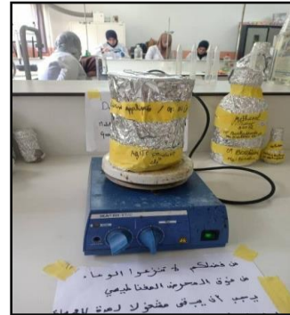
Macération sous agitation magnétique pendant 24 h
