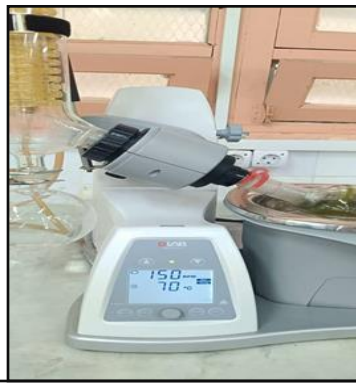
Evaporation à l'aide d'un rotavapeur
