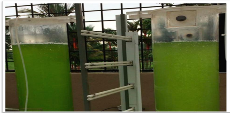
Figure II. 4: Modèle de photobioréacteurs tubulaires (Mohd Udaiyappan et al., 2017).
