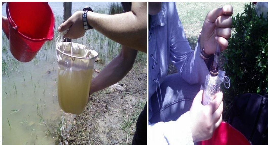
Figure III. 5: Echantillonnage des microalgues à l'aide d'un filet et remplissage des bouteilles en verre stériles (photos personnelles)
