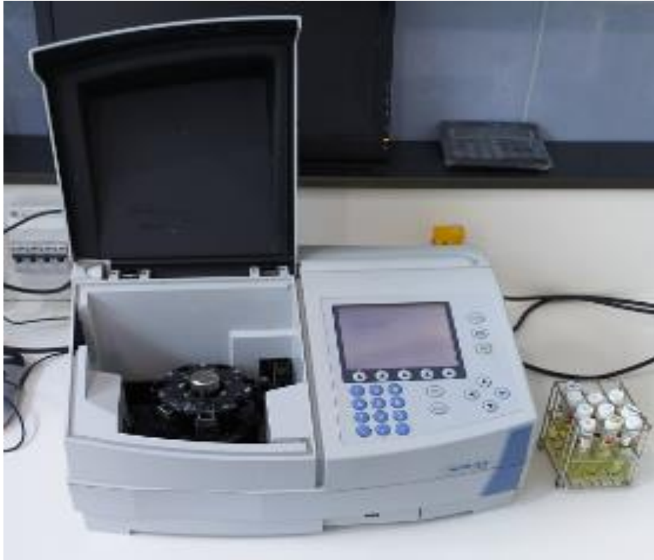
Figure III. 18: Mesure de DO par Spectrophotomètre (HELIOS EPSILON 3SGN006008 UV-VIS)
