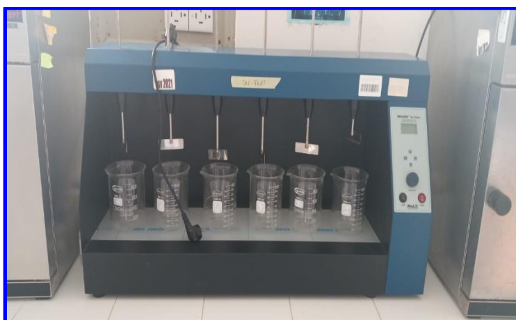
Figure I.3. Équipement d'essai de Jar-Test
