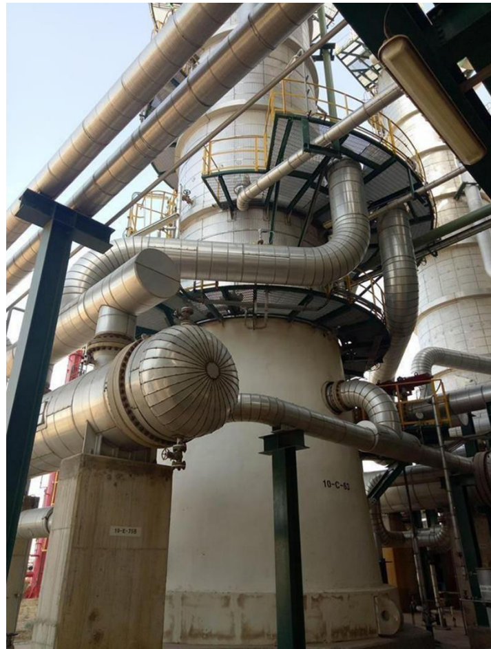
Figure 1 : La colonne 10-C-63 (séparation NAPHTA)
