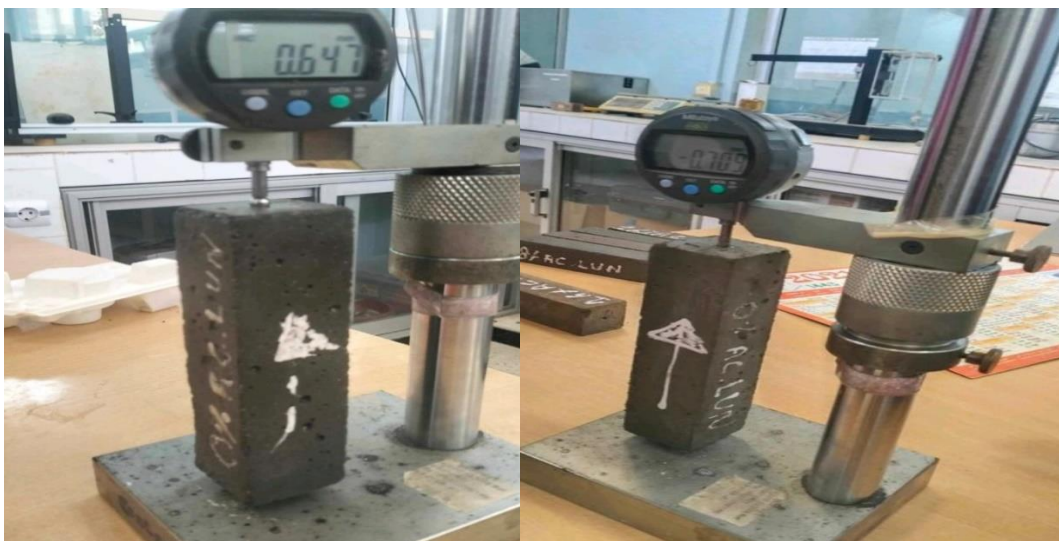
Figure III-14: Déformètre Figure III-15: Mesure du retrait
