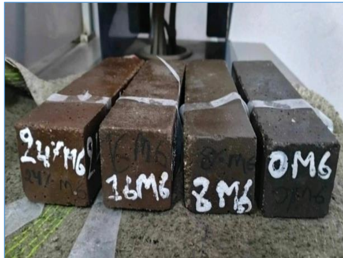
Figure III-18: Eprouvettes prismatiques 4x4x16 cm pour l'essai d'absorption par immersion
