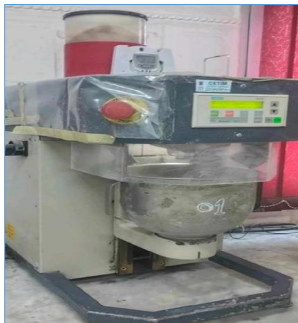
Figure III-1: Malaxeur à mortier
