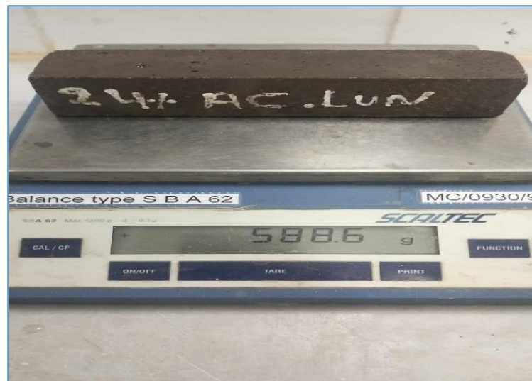
Figure III-17: Mesure du poids des éprouvettes
