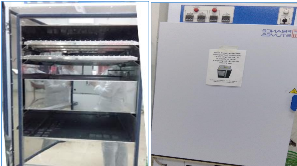
Figure III-5: Enceinte climatique Figure III-6: Etuve de laboratoire
