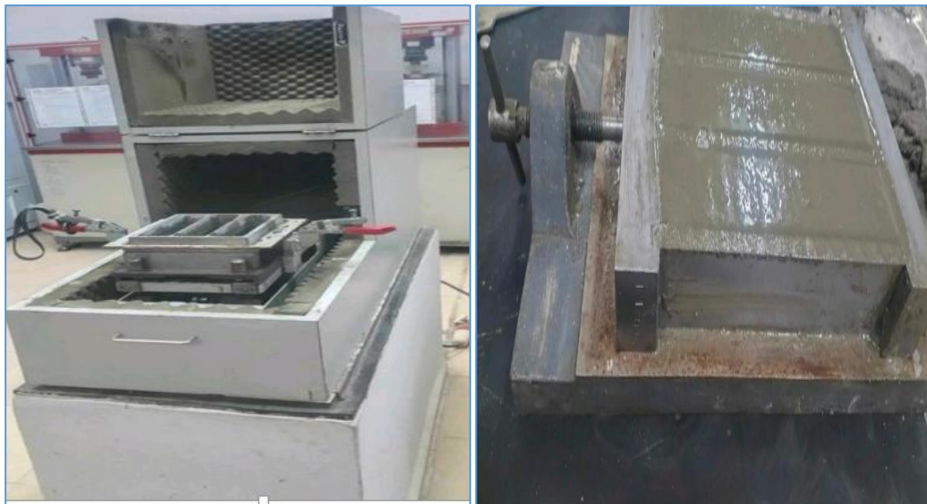
Figure III-4: Vibration par table à chocs et moule à l'état final
