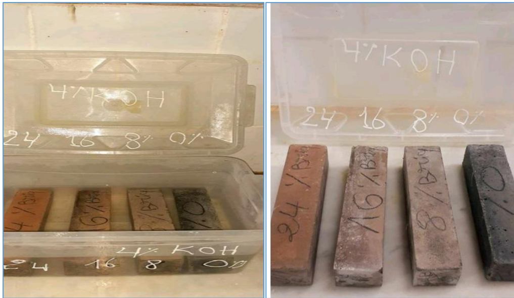
Figure III-21: Epreuves immergées dans la solution 4% KOH
