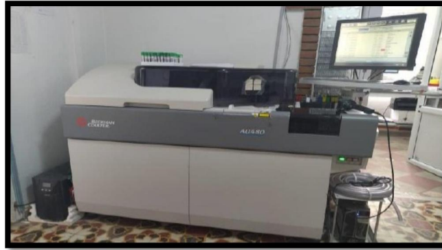
Figure 16 : L'automate des analyses biochimiques modèle BECKMEN COULTER-AU480 (Photo original 2024 ).
