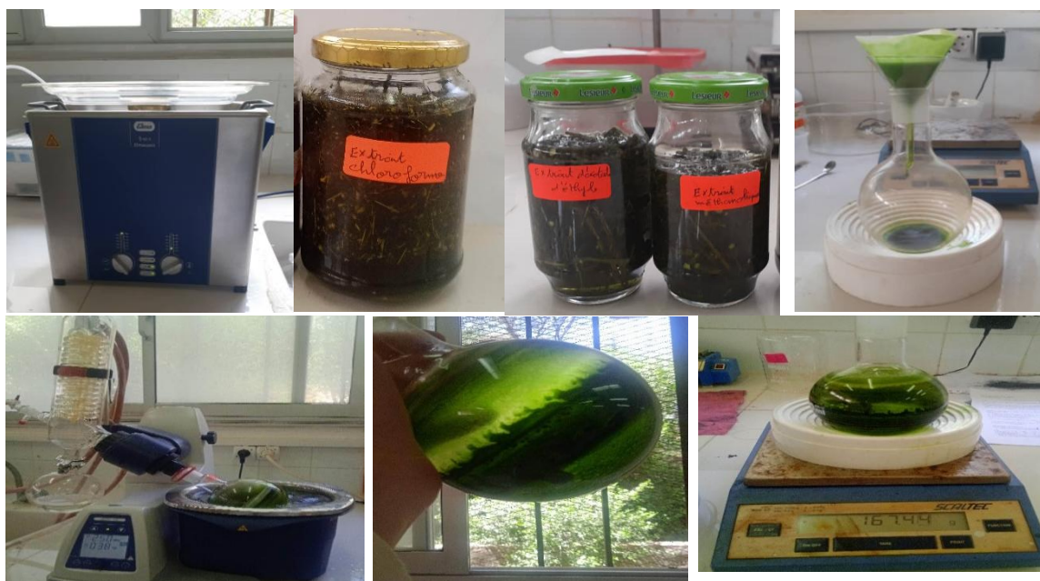
Figure II.3: Etapes d'extraction par ultrasons.
