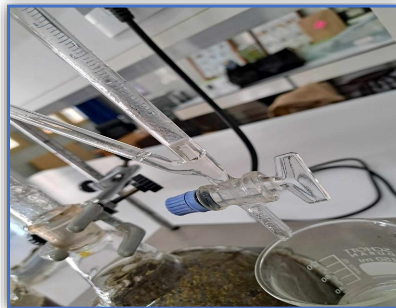
Figure 9. Huile essentielle condensé sur les parois de l'hydro-distillateur
