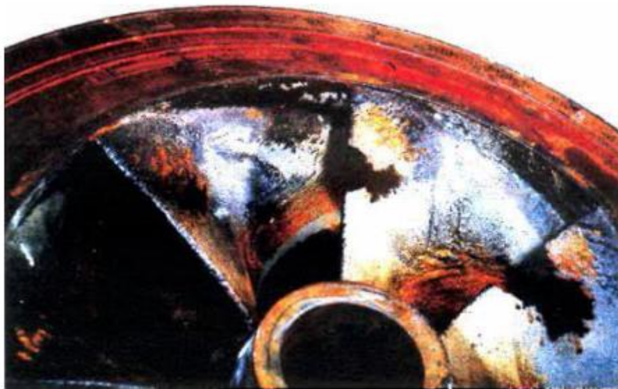
Figure III.19 : Érosion par cavitation d'une roue de pompe centrifuge [17].
