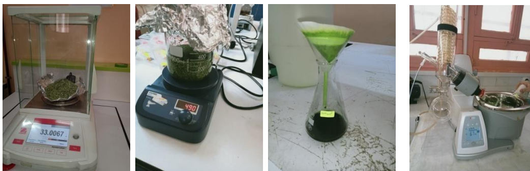
Figure II.6 : protocole de préparation d'extrait méthanoïque et éthanoïque qui explique dans la figure(II.5).
