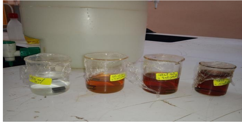
Figure II.9 : montage expérimental pour expérience de perte de masse en présence d'un inhibiteur +méthanol.
