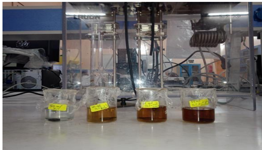
Figure II.8 : montage expérimental pour expérience de perte de masse en présence d'un inhibiteur +éthanol.
