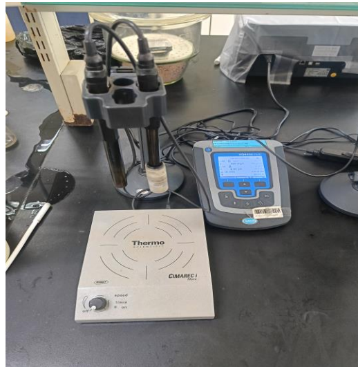
Figure II.8.pH-mètre, conductimètre et TDS mètre de paillasse
