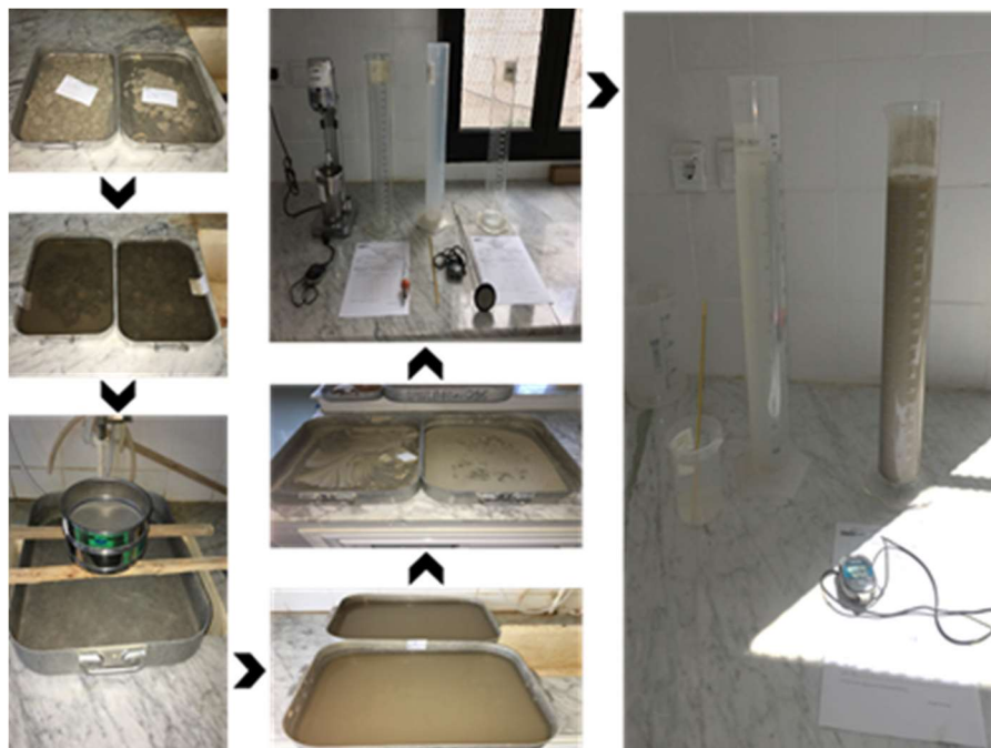
Figure 2- 3. Étapes de préparation des échantillons pour l'analyse granulométrique par tamisage et par sédimentométrie.
