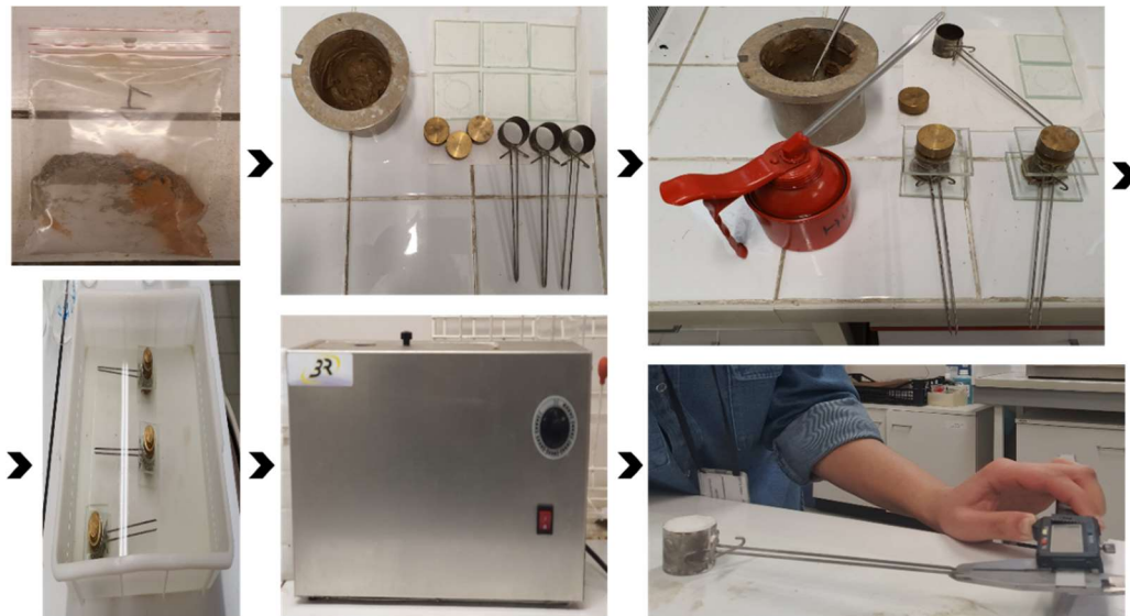
Figure 3- 12. Mesure d'expansion des différentes pâtes de ciment.
