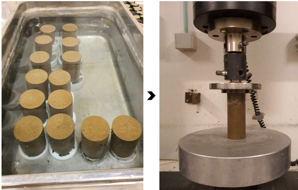
Figure 4- 20. Mode de conservation et écrasement des éprouvettes destinées à l’essai de résistance à l’immersion.
