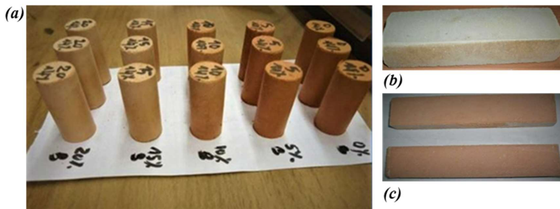
Figure 1- 7. (a). Briques cuites à base de sédiments du port de Bethioua [104], (b) BTC, (c) briques cuites à base de sédiments du barrage de Bouhanifia [75].
