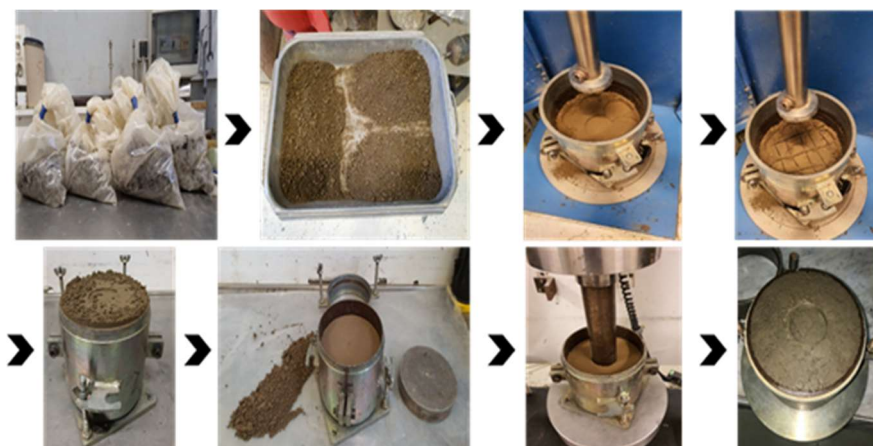
Figure 2- 19. Protocole de conservation et de réalisation de l'essai de poinçonnement sur les sédiments de Zardezas.
