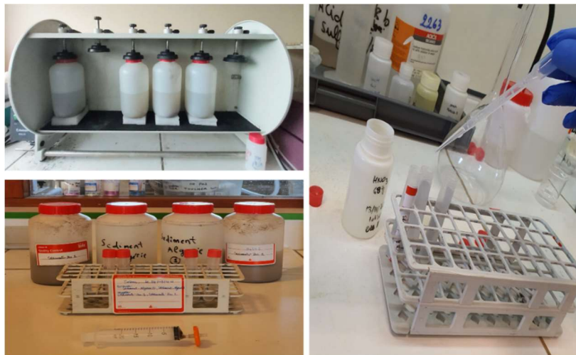
Figure 2- 22. Protocole de préparation des échantillons pour la détermination de la teneur en contaminants.
