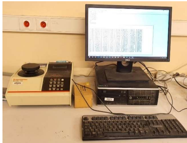
Figure 2- 7. Pycnomètre à hélium pour la mesure de la masse volumique absolue.
