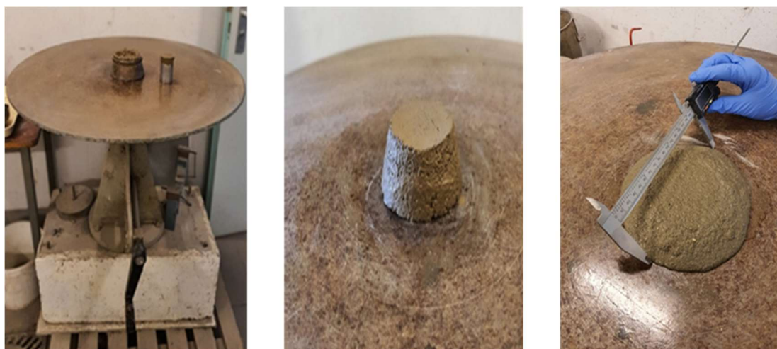
Figure 3- 10. Mesure de l'étalement à la table à choc des mortiers.
