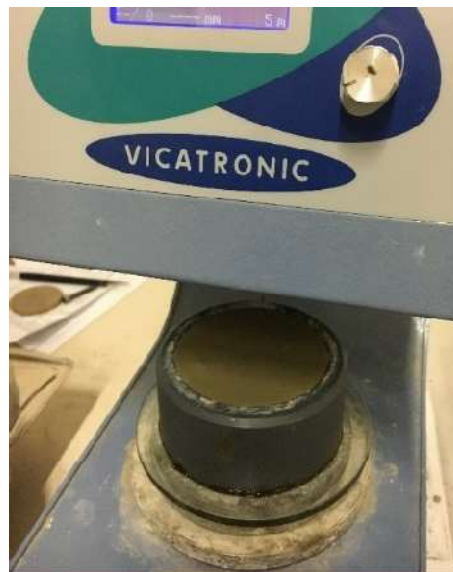
Figure 3- 11. Détermination du temps de prise pour la pâte de ciment.
