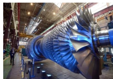
Fig-III.8- Turbine à Gaz [*].
