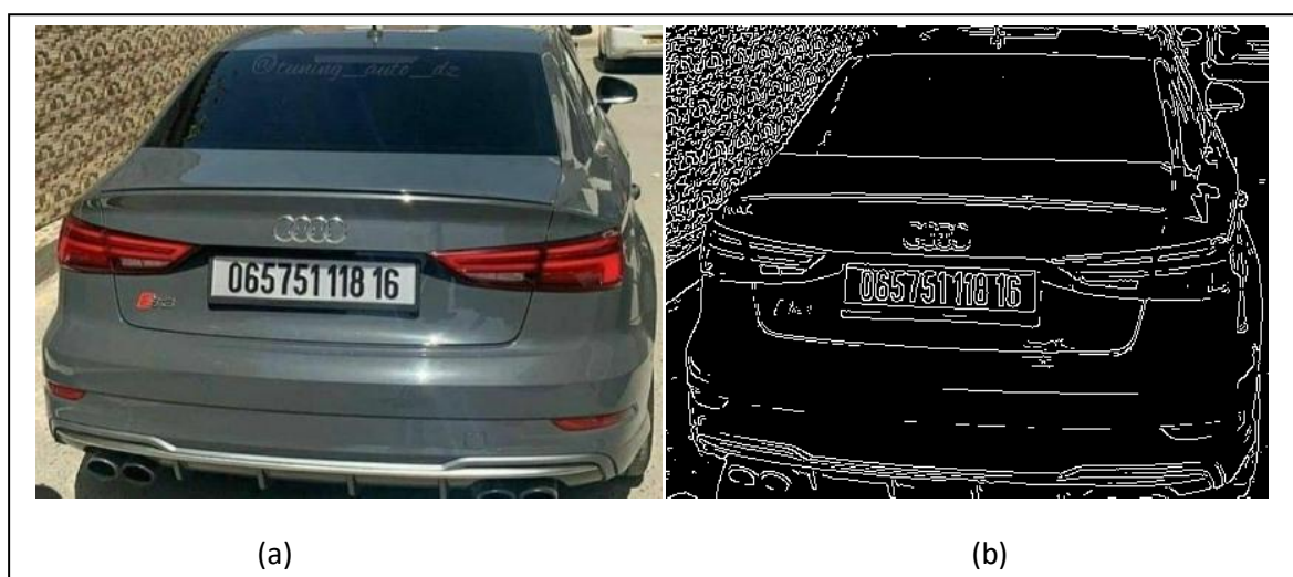
Figure 15: Image avant et après la conversion, (a) : Image originale, (b) : Image canny.
