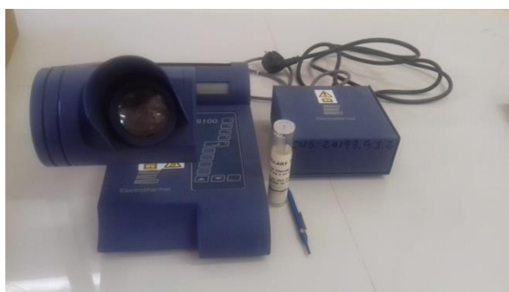
Figure I-46 : L'Electrothermal : appareil de mesure de la température de la fusion
