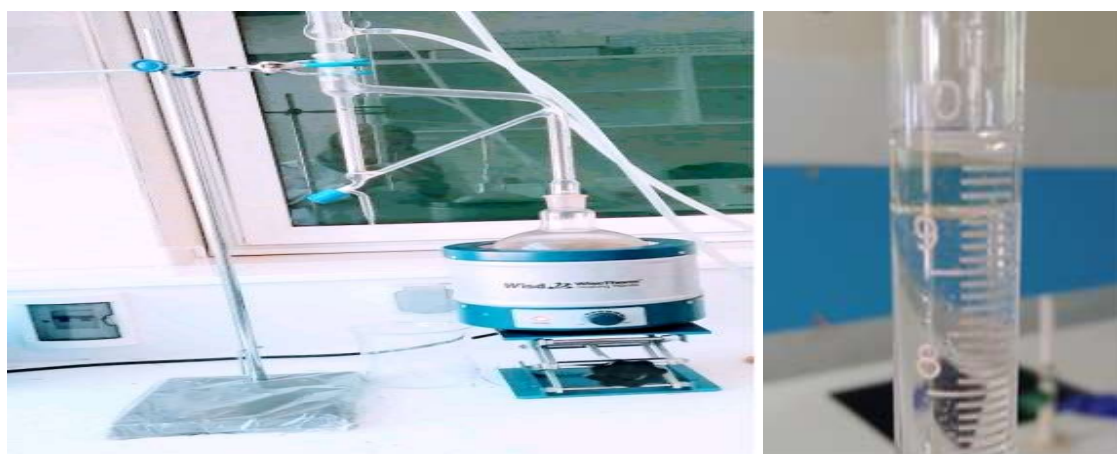
Figure 9 : Montage utilisée pour l'hydrodistillation (originale, 2023) et HEs du P. pinaster
