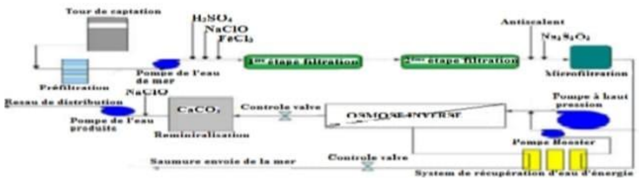
Figure (7). Schéma représentatif de la station de dessalement d'eau de mer de Skikda (Desaladora, 2005)
