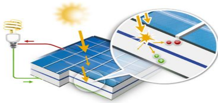
Figure (II- 1) : Principe de conversion de l'énergie solaire en énergie électrique dans une cellule photovoltaïque.
