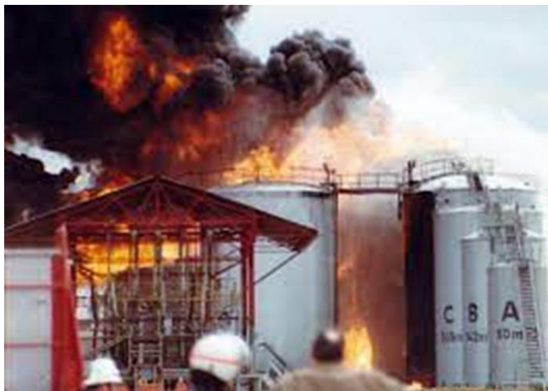
Figure VI.7 : Phénomène UVCE au niveau d'un bac de stockage 600.S.226
