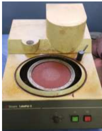
Figure IV. 2 : Une polisseuse mécanique
