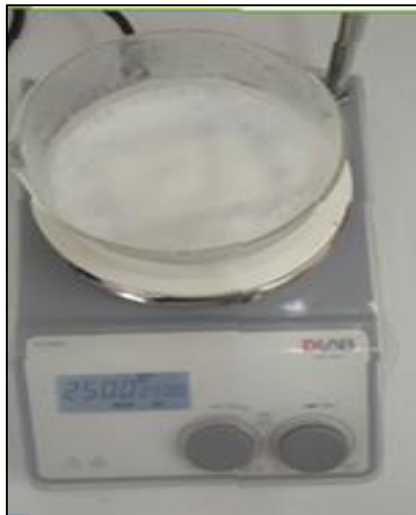
Figure III.16: formation du tartre après 30 min de chauffage.
