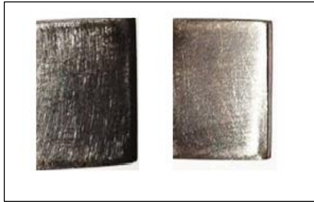
Figure III.2: échantillon après le découpage et polissage.
