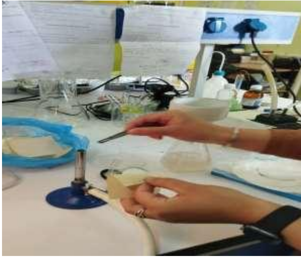
Figure III.10. Stérilisation de membrane
