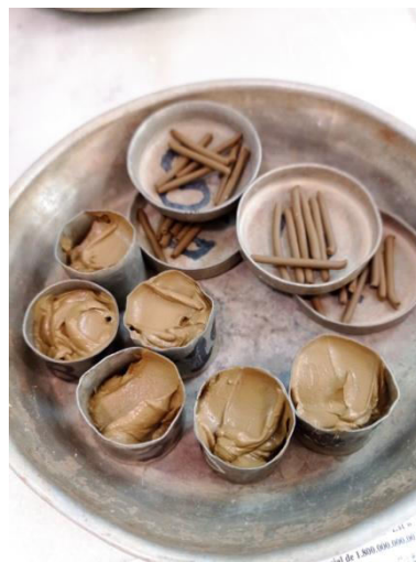
Figure II.16: Photo d'essais de limites d'Atterberg.
