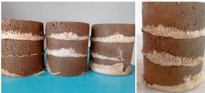
Figure II.35: Disposition des couches de géotextile
