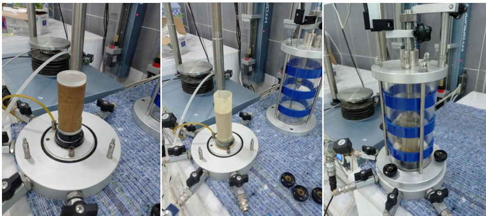
Figure II.21: Photos d'essais triaxiaux.
